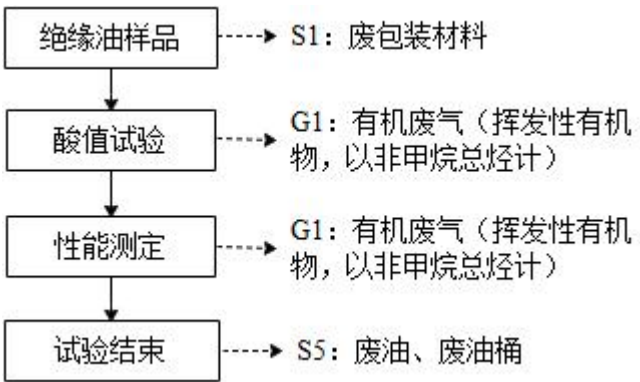
图 2-13 绝缘油酸值试验工艺流程及产污环节示意图
